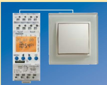
**Entrée de commande externe.** Grâce à cette entrée de commande externe, il est tout à fait possible de raccorder un interrupteur ou plusieurs boutons-poussoirs par canal. Les fonctions suivantes sont alors disponibles au choix : MARCHÉ en permanence, ARRÊT en permanence, présélection de commutation, horloge de temps écoulé pour la MARCHÉ et l'ARRÊT, ainsi que fonction d' minuterie d'escalier.
