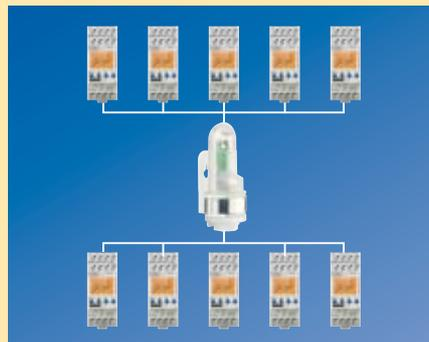
**Montage pratique.** Il est possible de raccorder jusqu'à 10 appareils numériques LUNA top2 à un capteur de luminosité numérique au moyen de 2 conducteurs seulement.
