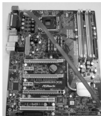
Collegare il cavo dati SATA al connettore eSATAII (eSATAII_TOP)
