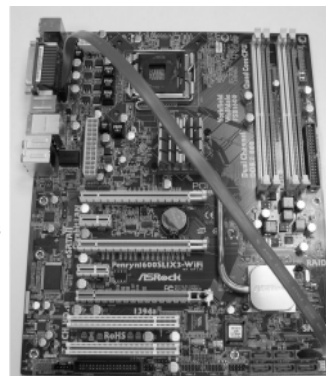
Connectez le câble de données SATA au connecteur SATAII (eSATAII_TOP)
