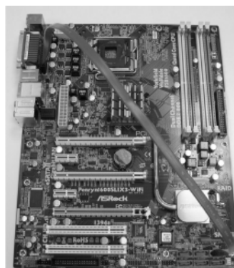
SATA データケーブルを赤いeSATAIIコネクタ(eSATAII_TOP)に接続します
