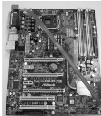
SATA 데이터 케이블을 빨간색 eSATAII 커넥터 (eSATAII_TOP)에 연결합니다.
