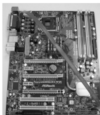
Conecte el cable de datos SATA al conector eSATAII (eSATAII_TOP)
