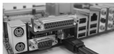
eSATAII デバイスケーブルのもう一方の端を I/O シールドの eSATAII ポート に接続します
