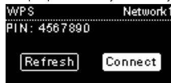
(3) Deschideți pagina Configurație WPS a AP-ului dumneavoastră pe calculator și introduceți codul PIN pentru stabilirea unei conexiuni.
