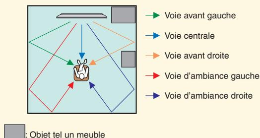
Installation de l'appareil dans un coin de la pièce
