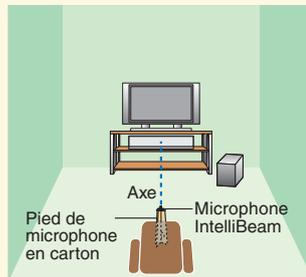
Disposez le microphone IntelliBeam à au moins 1,8 m du point central de l'appareil. Assurez-vous également de disposer le microphone IntelliBeam à moins de 1 m verticalement de part et d'autre de l'axe de l'appareil.
