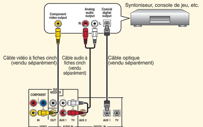
**Exemple - c** Cet exemple illustre le raccordement d'un appareil extérieur aux prises AUX2 (numérique coaxial) et COMPONENT VIDEO IN.
