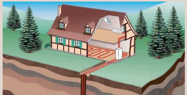
En géothermie, l'énergie est captée dans le sol par un réseau de capteurs enterrés dans lequel circule un fluide caloporteur antigel et anticorrosion. Ce réseau peut être horizontal (enfoui de 60 à 80 cm de profondeur dans le sol) ou vertical (profondeur allant de 60 à 100 m).
