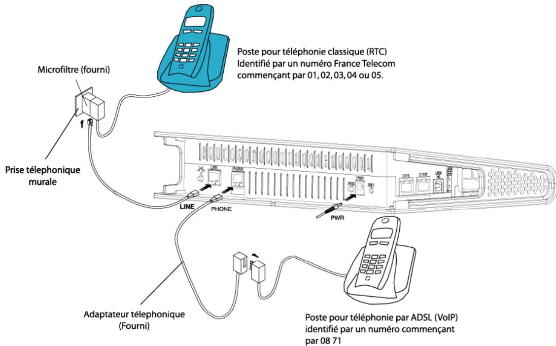
**Figure 2.3 - Branchement ligne ADSL/ Poste téléphonique / Alimentation du SAGEM F@st™ 3202**
