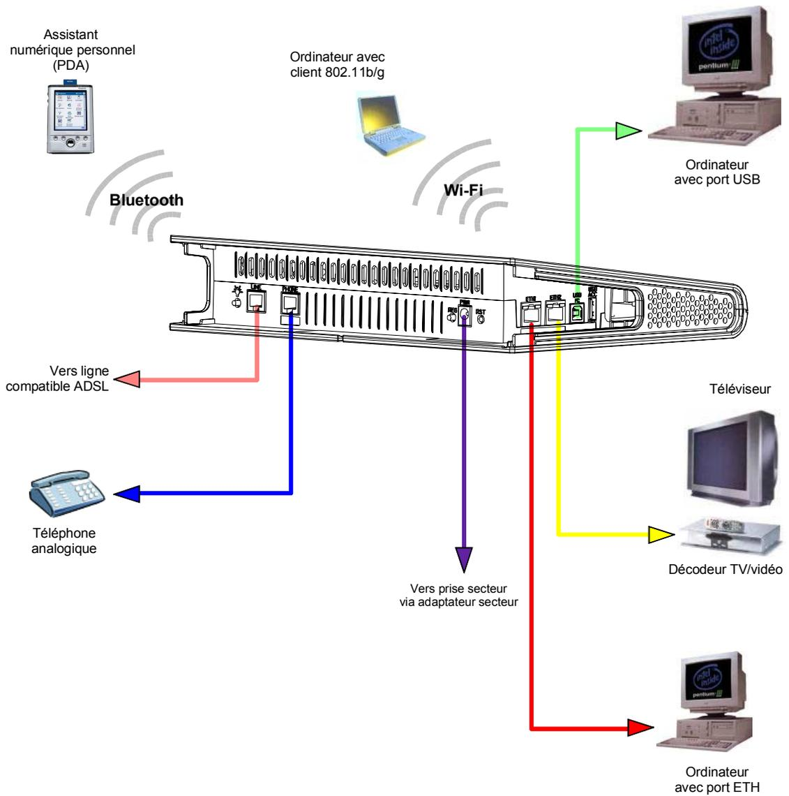
Figure 2.2 - Interconnexion des accès du SAGEM F@st™ 3202
