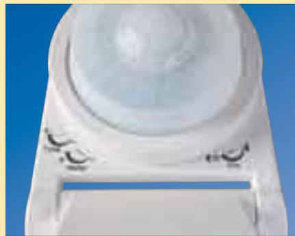
Le réglage s'effectue sous le capteur grâce à 3 potentiomètres dédiés au seuil de luminosité (Lux), à la durée d'éclairage (Time) et à la largeur de détection (Meter).
