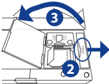
5. Insérez la carte SIM avec ses contacts dorés dirigés vers le bas (vérifiez le connecteur de carte SIM pour l'orientation correcte lors de l'insertion de la carte SIM).
