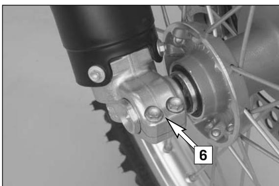
Pour la pose de la roue, présenter celle-ci dans la fourche, la mettre en position et enfiler l'axe.
