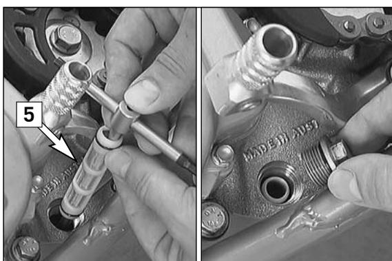
Pour monter la crépine longue [5], l'enfiler sur une tige ou une clé d'environ 300 mm. Enfiler la tige par le trou et jusque dans l'alésage pratiqué dans la paroi opposée du carter. Faire alors glisser la crépine sur la tige jusqu'en butée. Retirer la tige, mettre le bouchon et le serrer à 15 Nm.
