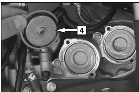
Mettre la machine sur le côté et remplir les deux filtres environ à moitié avec de l'huile moteur. Remplir les filtres d'huile. Enfiler les filtres à huile dans le carter, le long à l'avant et le court à l'arrière.
