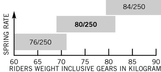
D'après notre expérience, l'amortissement à la compression peut rester tel qu'il est. Pour un ressort plus faible, l'amortissement à la détente peut être diminué de quelques crans; pour un ressort plus fort, il peut être augmenté de quelques crans.
