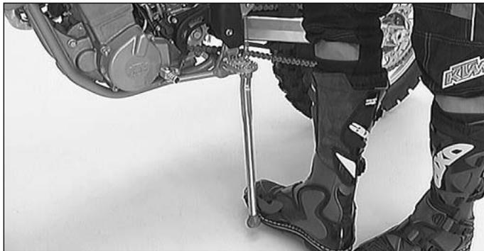
Remarque concernant la béquille latérale: Avec le pied pousser la béquille vers l'avant jusqu' en butée et incliner la moto. Faire attention à ce que le sol soit dur et à ce que la machine tienne bien en place. Par sécurité on peut enclencher une vitesse.
