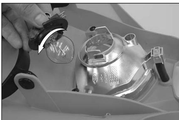
Mettre une ampoule neuve de manière à ce que les tétons [7] s'engagent dans les logements [8]. Ne pas toucher le verre de l'ampoule pour ne pas y laisser de traces de gras. Accrocher l'épingle, mettre le capuchon en caoutchouc et rebrancher la cosse.
