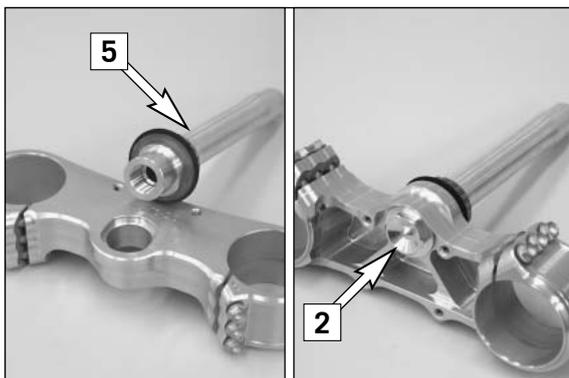
Enlever la vis à épaulement située sur le té inférieur et sortir la potence. Nettoyer soigneusement toutes les pièces. Remettre la potence dans le té inférieur après lui avoir fait faire un demi-tour (180°) et visser la vis à épaulement jusqu'en butée.
