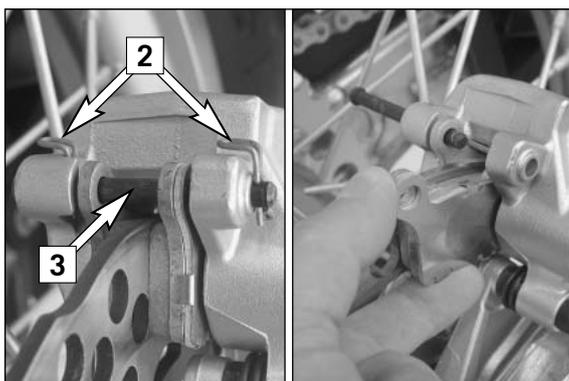
Enfiler la plaquette gauche dans la pince et la maintenir en place au moyen du doigt. Enfiler la plaquette droite et enfoncer le doigt [3] dans la pince jusqu'en butée. Remettre les goupilles [2].
