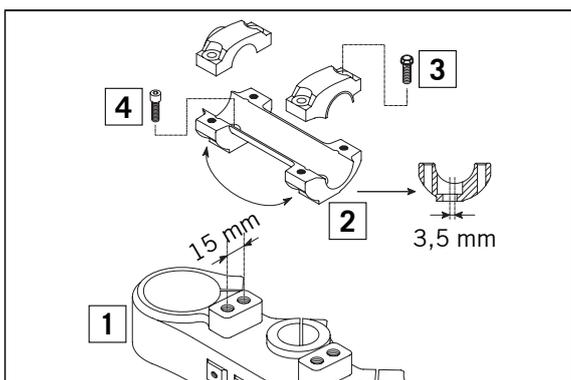
Enlever les vis [3] des demi-coquilles supérieures et les vis [4] du support de guidon. Choisir la position pour le support et serrer les vis [4] à 40 Nm. Mettre en place le guidon et les demi-coquilles et serrer les vis [3] à 20 Nm. L'espace entre le support de guidon et les demi-coquilles doit être le même vers l'avant et vers l'arrière.
