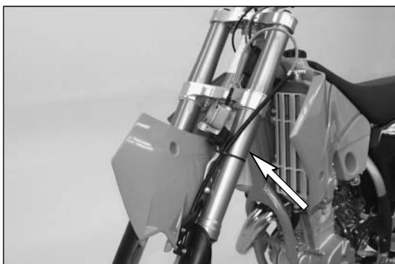
Pour régler le déport, déposer la roue avant ainsi que le garde-boue. Retirer la vis de la plaque de numéro. Enlever les vis de fixation du maître-cylindre de frein et fixer ce dernier avec un collier ou similaire au bras de fourche gauche afin que la durite de frein ne fasse pas un croc (voir illustration).
