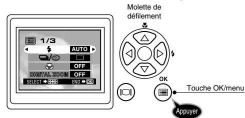
3. Sélectionner **🌿** en appuyant sur **▲** ou **▼** de la molette de défilement.
