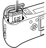
4. Refermer le couvercle du compartiment des piles dans le sens de la flèche ①, et appuyer sur le couvercle dans le sens de la flèche ② jusqu'à ce qu'il s'enclenche.
