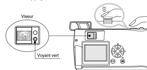
4. Appuyer complètement sur le déclencheur pour prendre la vue.
