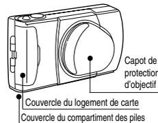
2. Faire coulisser le couvercle du compartiment des piles dans le sens de la flèche ①, et lever le couvercle dans le sens de la flèche ②.
