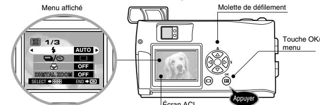
3. Sélectionner ⚡ en appuyant sur ▲ ou ▼ de la molette de défilement.
