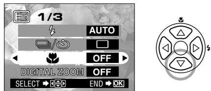
4. Sélectionner "ON" en appuyant sur **◀** ou **▶** de la molette de défilement.
