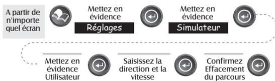
**Désactivation du simulateur** — Désactive le simulateur et revient au fonctionnement normal du SporTrak. A partir de n'importe quel écran
