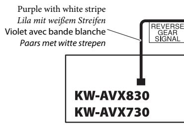
Extension lead (not supplied for this unit) / Rückwärtsgangsignal-skabel (wird nicht mit Gerät mitgeliefert) / Fil prolongateur (non fourni avec cet autoradio) / Verlengsnoer (niet bij het apparaat inbegrepen)
