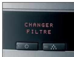
Le filtre est épuisé après le prélèvement de 50 litres d'eau.
