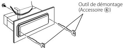
4. Baissez l'outil de démontage vers le bas et tirez l'appareil à moitié en faisant pression vers l'intérieur.
