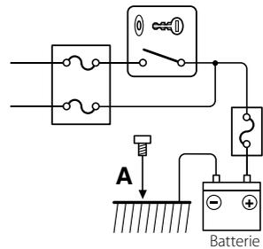
**⚠** Si vous connectez le câble d'allumage (rouge) et le câble de batterie (jaune) au châssis de la voiture (masse), vous risquez de causer un court-circuit qui peut provoquer un incendie. Connectez toujours ces câbles à la source d'alimentation de la boîte à fusible.
