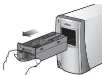
**c** Insérez le SA-21 dans la fente pour adaptateur.
