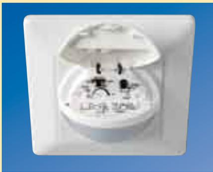
Le réglage du modèle LUXA 103-200 s'effectue sous le cache par le biais de 3 potentiomètres dédiés au seuil de luminosité (Lux), à la durée d'éclairage (Time) et à la largeur de détection (Meter), ainsi que d'un avertissement d'interruption activable.
