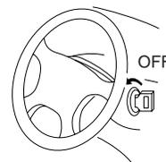
**8****Retirez la clé de contact puis de nouveau l'extrémité (-) de la batterie pour commencer la procédure d'installation.**
