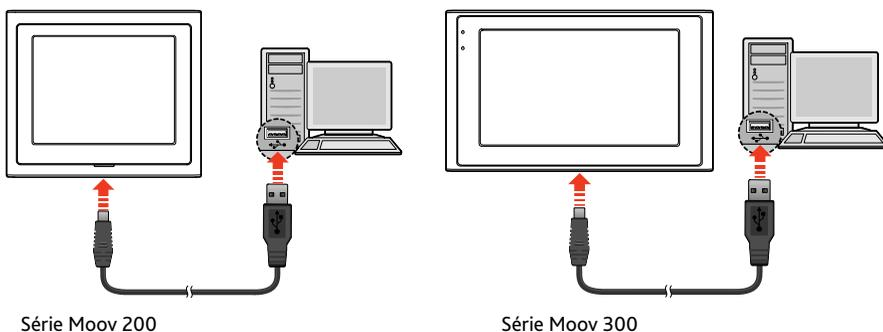
3. L'indicateur de charge est de couleur orange pendant la charge. Lorsque la batterie est entièrement chargée, l'indicateur devient vert.
