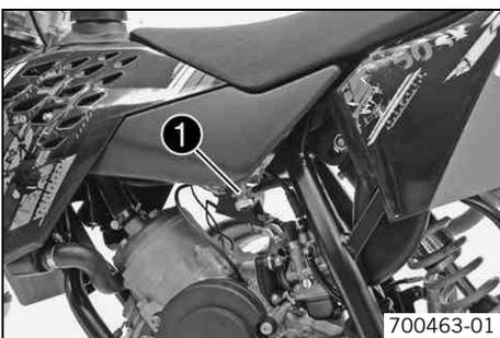
Le robinet de carburant ❶ se trouve du côté gauche du réservoir de carburant.
