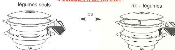
1. Verser 1 litre d'eau dans la base de l'appareil.
