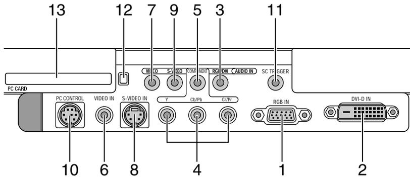
1. RGB IN / Component Input Connector (Mini D-Sub 15 Pin)
