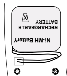
placer les fils du connecteur comme indiqué (étiquette avec texte à l'envers)
