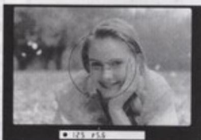
L'ouverture que vous avez sélectionnée ainsi que la vitesse automatiquement déterminée apparaissent en-dessous de la plage de visée.
