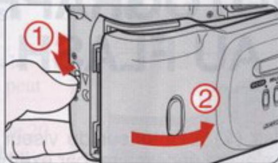
1. Assurez-vous qu'aucun film n'est chargé dans l'appareil et ouvrez le dos de l'appareil.
