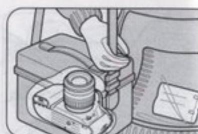
4. Par grand froid, la capacité des piles diminue. Veillez à bien avoir mis une pile neuve et enveloppez votre boîtier dans quelque chose de chaud.
