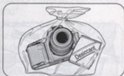
11. Rangez votre appareil dans un endroit frais et sec à l'abri de la naphthaline ou du camphre (tout produit à éloigner les mites). En cas d'environnement humide, rangez votre appareil dans un sac en vinyle avec un dessicant pour le protéger de la poussière, l'humidité et du sel. Notez, cependant, que le rangement des étuis en cuir dans un sac en vinyle risque d'altérer le cuir.
