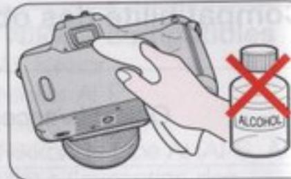
4. Nettoyez l'oculaire du viseur avec un chiffon doux et propre. N'utilisez pas d'alcool.
