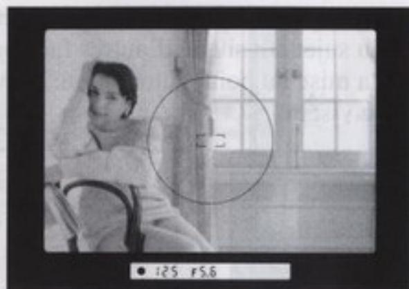
**4** Tout en maintenant la commande AE-L pressée, recadrez et pressez franchement le déclencheur.
