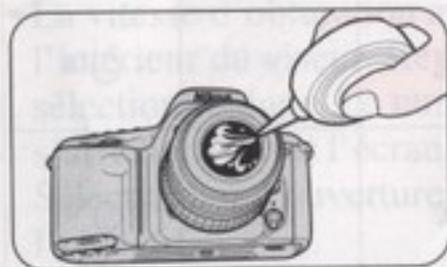
5. Nettoyez les surfaces optiques comme l'objectif ou l'oculaire avec un pinceau soufflant; n'utilisez pas de mouchoir en papier pour objectif, de chiffon à lunettes aux silicones, etc.... Pour éliminer la saleté et les tâches, utilisez un chiffon doux en coton, légèrement imbibé d'alcool pur et nettoyez en effectuant un mouvement en spirale du centre à la périphérie. Ne laissez pas de traces.
