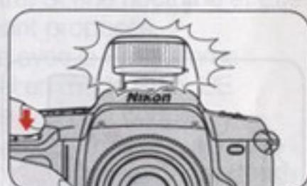
12. Pour conserver le condensateur du flash intégré en excellente condition, et ainsi vous permettre de l'utiliser pendant de nombreuses années, déclenchez mensuellement quelques éclairs.
