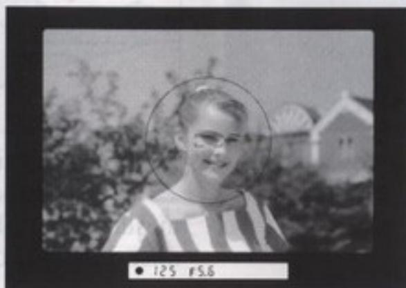
**2** Contrôlez l'apparition de ● (indicateur de mise au point correcte dans le viseur). La mise au point reste mémorisée tant que vous gardez le déclencheur légèrement sollicité.
