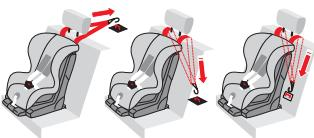
⇨ Навесьте карабинный крючок **48** на рекомендованную в руководстве по эксплуатации автомобиля точку анкерного крепления *TopTether*(например, на полке заднего стекла, на полу или за спинкой сиденья).
