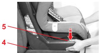
Drücken Sie links und rechts am Sitzunterteil auf die grauen Sicherungsknöpfe 5. Die Rastarme 4 lösen sich.
