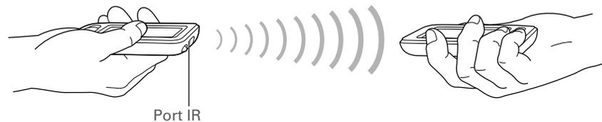
**REMARQUE** Pour des résultats optimaux, les ordinateurs de poche doivent être séparés d'une distance comprise entre 10 et 90 cm et aucun obstacle ne doit se trouver entre eux. En fonction du modèle d'ordinateur de poche récepteur, il se peut que certaines informations ne soient pas reçues correctement.
