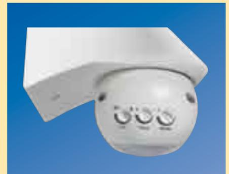
Le réglage est réalisé par l'arrière de la tête sphérique grâce à 3 potentiomètres dédiés au seuil de luminosité (Lux), à la durée d'éclairage (Time) et à la largeur de détection (Meter).
