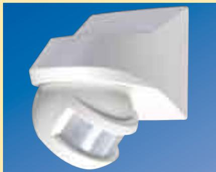
Le montage s'effectue sans aucune difficulté du fait de la zone de détection réglable de manière optimale. En effet, la tête du capteur pivote à 180° et s'incline de 0 à 40°.
