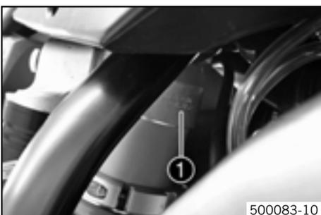
La référence de l'amortisseur ❶ est estampée sur la partie supérieure de l'amortisseur, au-dessus de l'écrou de réglage, côté moteur.
