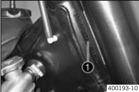
Le numéro de châssis ❶ est imprimé à droite sur la tête de direction.
