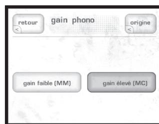
Le menu **gain Phono (phono gain)** n'est actif que si le **module optionnel Phono (phono module)** est installé ; dans le cas contraire, il reste grisé. Lorsqu'il est installé, le CP-700 le reconnaît automatiquement, renomme l'entrée « **line 1** » en « **phono** », et active cette entrée dans le menu principal.
