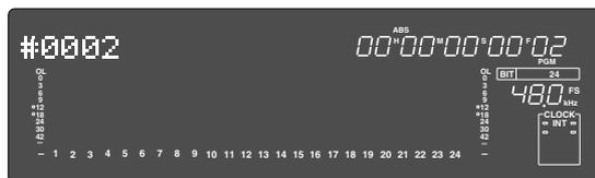
Normalement, tout nouveau Programme compilé aura la fréquence d'échantillonnage établie lors du formatage du disque actif. Toutefois, dans cet enregistreur, il est possible de changer la fréquence d'échantillonnage du Programme. En d'autres termes, des Programmes ayant des fréquences d'échantillonnage différentes peuvent cohabiter sur le disque actif et vos enregistrements peuvent donc être adaptés à une tâche particulière. Pour des détails, référez-vous en page suivante.
