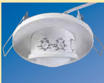
LUXA 103-360 à un canal. Le réglage s'effectue sous le cache du capteur grâce à 3 potentiomètres dédiés à la luminosité (Lux), à la durée d'éclairage (Time) et à la largeur de détection (Meter).
