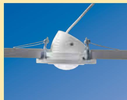
La fixation du capteur au plafond est sécurisée par 2 bornes à ressort. Diamètre de perçage : 65 à 68 mm, épaisseur de paroi jusqu'à 25 mm.
