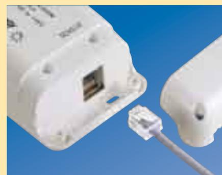
Une Power-Box séparée dotée d'un connecteur à enficher sur le capteur permet de procéder au montage dès l'étape du gros œuvre ou plus tard, en l'enfonçant dans la découpe au plafond (Ø = 65 mm).
