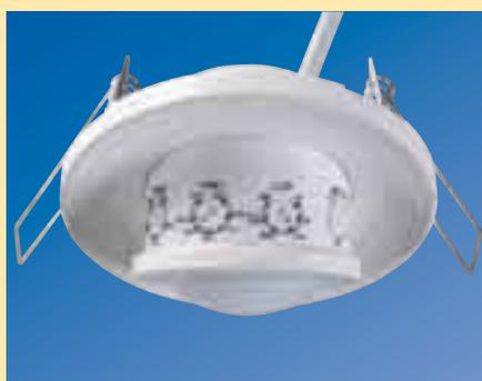
LUXA 103-360/2 à deux canaux. Le réglage s'effectue sous le cache du capteur grâce à 4 potentiomètres dédiés au seuil de luminosité (Lux), à la durée d'éclairage (Time) et à la largeur de détection (Meter).
