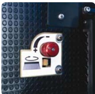
La vitesse de brosse réglable permet à la machine de fonctionner sur toutes les surfaces de voirie, quel que soit le niveau de saleté (en option).
