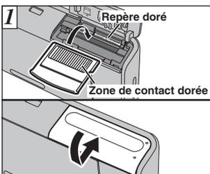
1. Alignez le repère doré sur la fente d'insertion de la carte xD-Picture Card avec la zone de contact dorée sur la carte xD-Picture Card et poussez ensuite fermement la carte à fond dans la fente. Fermez le couvercle du compartiment batterie.
