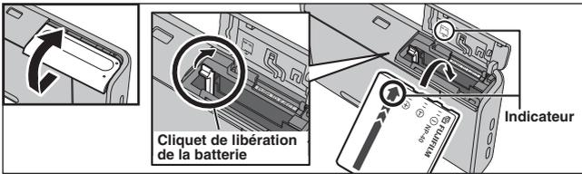
Déplacez du doigt le cliquet de libération de la batterie et introduisez la batterie comme le montre l'illustration. Poussez le cliquet de libération de la batterie sur le côté pour mettre la batterie en place. Vérifiez si la batterie est bien maintenue en place.
