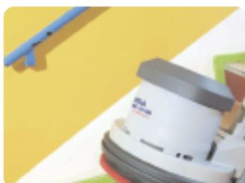
Les grandes roues permettent de déplacer la machine sur des seuils, des marches en montant et en descendant les escaliers.
