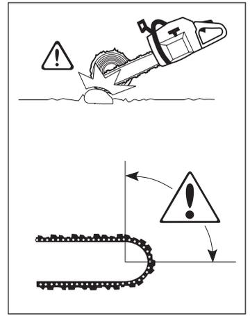
Si la chaîne se coince ou si la pièce à scier se casse, cela dépend de deux raisons : le support de la pièce avant et après le sciage, et l'état de tension de la pièce.
