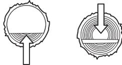
3 Les deux extrémités du tronc reposent sur des supports. Risque important de coinçage de la chaîne.
