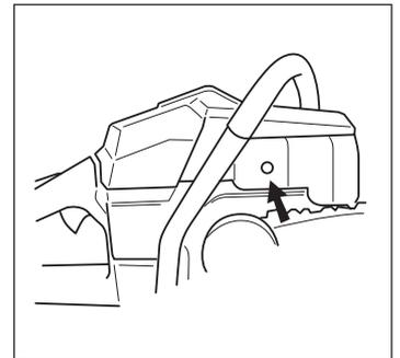
Attention. Si l'on utilise le kit spécial d'hiver ou si l'on prend des mesures pour augmenter la température, il faut revenir au réglage normal, étant que la tronçonneuse fonctionne alors à la température normale. Sinon il y a risque de surchauffe avec pour conséquence de graves dommages au moteur.
