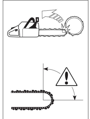
Le rebond se produit toujours dans le plan du guide-chaîne. En général, tronçonneuse et guide-chaîne sont relevés simultanément en direction de l'opérateur. Néanmoins, le direction du rebond peut varier suivant la position du nez au moment où il touche un objet quelconque.
