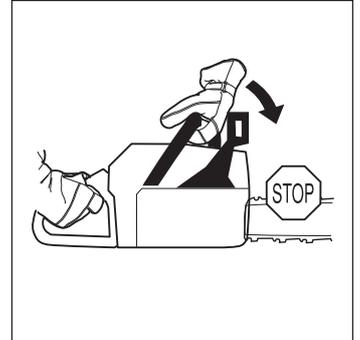
• Ne pas mettre la machine en route sans que le guide-chaîne, la chaîne et l'embrayage soient correctement montés. (Voir au chapitre "Montage").
