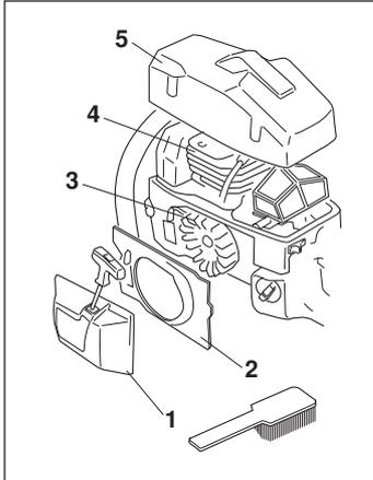
Une fois par semaine, nettoyer le système de refroidissement avec une brosse; dans les conditions sévères, plus souvent. **Un système de refroidissement sale ou colmaté provoque une surchauffe de la tronçonneuse, ce qui entraîne l'endommagement du cylindre et du piston.**
