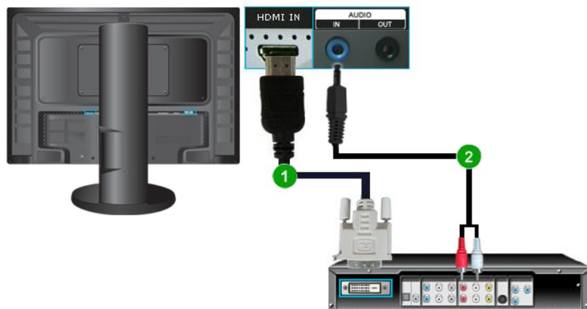
1. Connectez la borne de sortie DVI d'un périphérique de sortie numérique à la borne *HDMI IN* du moniteur à l'aide d'un câble DVI vers HDMI.
