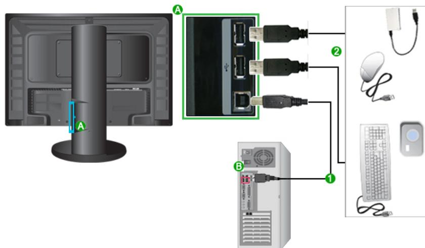
1. Connectez le port
