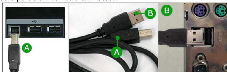
2. Connectez le port
