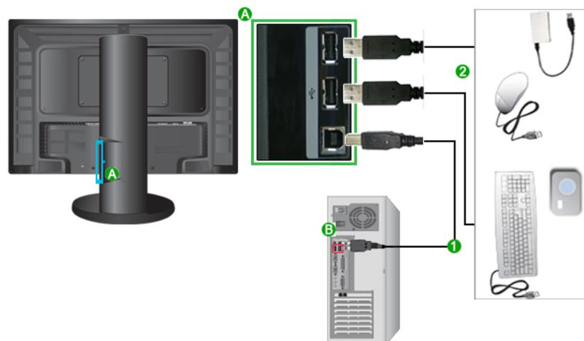
1. Connectez le port
