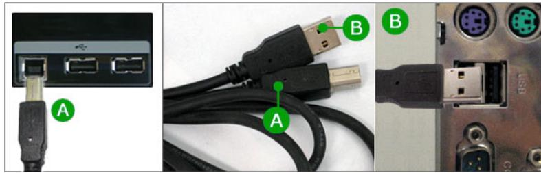
2. Connectez le port
