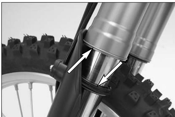
Nettoyer à fond les cache-poussière, les tubes plongeurs et les tubes extérieurs et bien les lubrifier avec un lubrifiant universel en aérosol (Motorex Joker 440) ou avec de l'huile moteur. A la main, renfoncer les cache-poussière dans leur logement.
