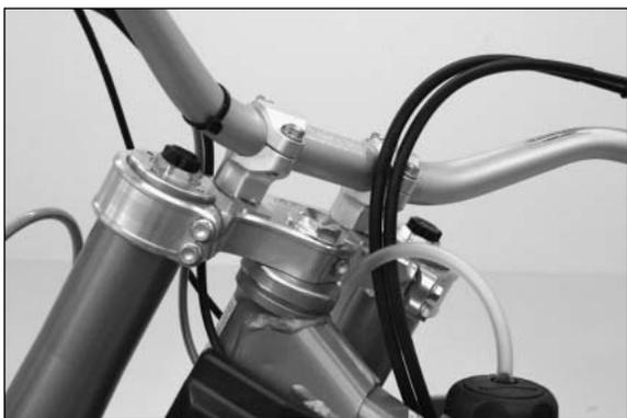
Monter le té inférieur, le roulement supérieur, le joint de protection, le joint torique, le té supérieur et la vis du haut.
