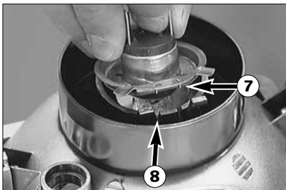
Mettre une ampoule neuve de manière à ce que les tétons ⑦ s'engagent dans les logements ⑧. Ne pas toucher le verre de l'ampoule pour ne pas y laisser de traces de gras. Accrocher l'épingle, mettre le capuchon en caoutchouc et rebrancher la cosse.
