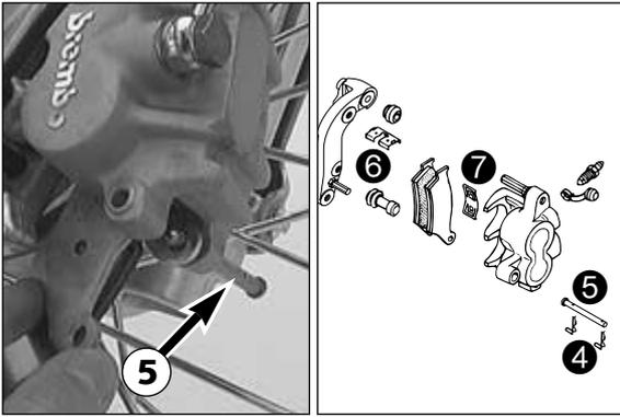
Mettre la plaquette droite et la maintenir en place au moyen du doigt d'arrêt. Mettre la plaquette gauche et enfiler alors le doigt d'arrêt à fond. Remettre les goupilles.
