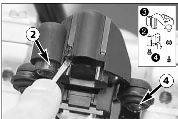
Avec un tournevis faire sortir du boîtier ❸, vers le bas, le cache bleu ❷ du compteur. Il suffit pour cela de déclipser au niveau des deux tétons ❹. Enlever les vis ❹ et sortir le compteur de son boîtier.
