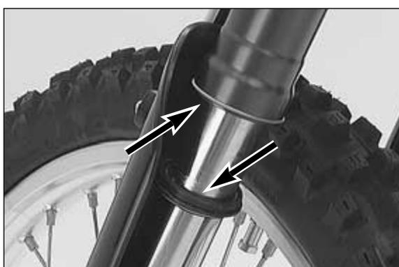
Nettoyer à fond les cache-poussière, les tubes plongeurs et les tubes extérieurs et bien les lubrifier avec un aérosol au silicone ou avec de l'huile moteur. A la main, renfoncer les cache-poussière dans leur logement.
