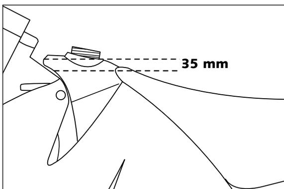
Le carburant augmente de volume avec la température. Ne pas remplir le réservoir à ras bord (Cf. Figure).
