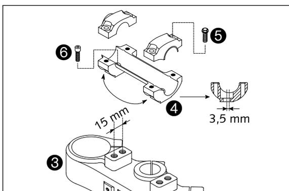
Enlever les vis ❺ des demi-coquilles supérieures et les vis ❻ du support de guidon. Choisir la position pour le support et serrer les vis ❻ à 40 Nm. Mettre en place le guidon et les demi-coquilles et serrer les vis ❺ à 20 Nm. L'espace entre le support de guidon et les demi-coquilles doit être le même vers l'avant et vers l'arrière.
