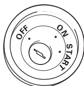
Assenza di posizione ACC
