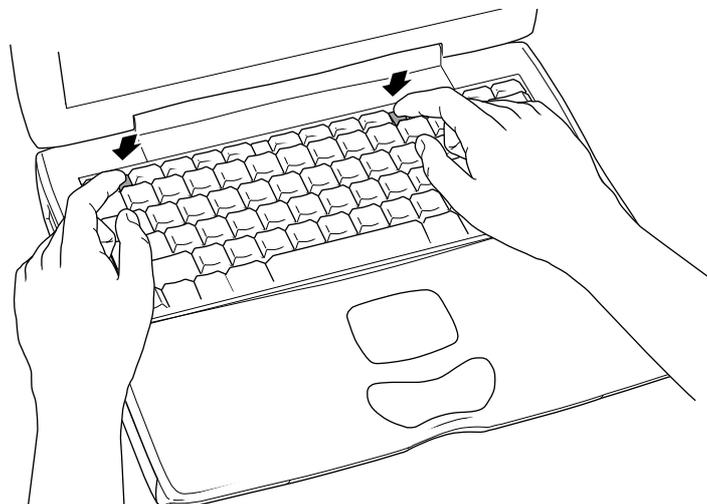
8. Laissez s'enclencher les attaches de libération du clavier pour qu'il se mette bien en place.
