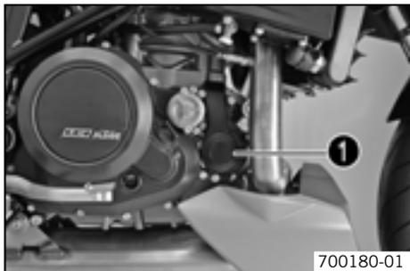
La pompe à eau ❶ provoque une circulation forcée du liquide de refroidissement dans le moteur.
