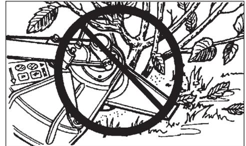
**La lame à herbes 8 dents** réf. 69600120331 est conçue pour le gazon, les débris et les mauvaises herbes épaisses. **NE PAS** utiliser cette lame pour tailler des broussailles ou des arbustes de 19 mm (3/4 po) de diamètre ou plus.
