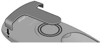
Placer le clip ceinture à l'arrière du combiné et appuyer jusqu'à ce que les ergots disposés latéralement s'enclenchent dans les trous.
