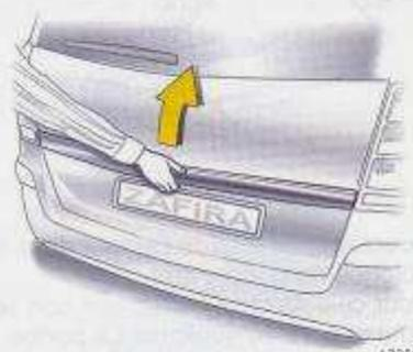
Déverrouiller et ouvrir le hayon en tirant sur la touche sous la moulure.
