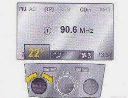
Les températures peuvent être présélectionnées à des valeurs entre 16 °C et 28 °C.
