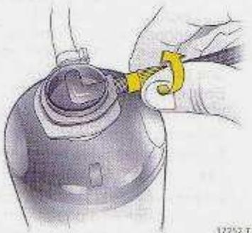
2. Dérouler le flexible d'air du support et le visser à l'orifice de la bombe de produit d'étanchéité.
