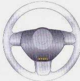
Le système d'airbags avant se compose d'un airbag dans le volant et d'un airbag dans le tableau de bord, reconnaissables aux inscriptions **AIRBAG**.
