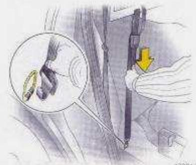
17394 T Accrocher le crochet des sangles de tension du filet dans les anneaux d'arrimage du plancher et le serrer.
