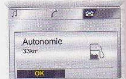
Si le contenu du réservoir ne permet pas de parcourir 50 km, le message « Autonomie » apparaît sur l'affichage.
