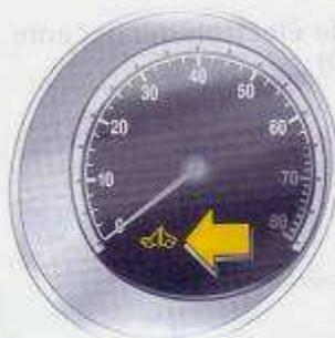
Après la mise du contact, le témoin s'allume un bref instant. Si le témoin clignote lorsque le contact est mis, c'est qu'il y a une défaillance. Le moteur ne peut pas démarrer. Couper le contact et le remettre.
