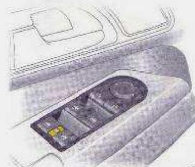
Le fonctionnement des commutateurs dans les portes arrière est activé (champ vert visible) ou désactivé (champ rouge visible) au moyen du commutateur
