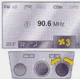
Tourner le bouton rotatif vers la gauche ou vers la droite. Le niveau de soufflerie choisi est indiqué sur l'affichage par un et un chiffre.
