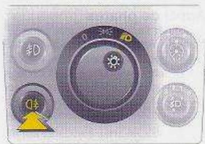
Le feu antibrouillard arrière s'allume uniquement avec le contact d'allumage mis et les feux de position ou de croisement allumés.
