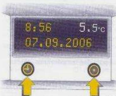
L'Infotainment System \* doit être arrêté. Pour appeler le mode de réglage, appuyer pendant env. 2 secondes sur la touche **INFO**. La touche **SET** permet de régler la valeur
