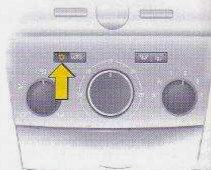
Fonctionne uniquement lorsque le moteur tourne et que la soufflante est enclenchée. Allumer et éteindre avec la touche ⚙.
