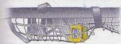
Placer la bande Velcro à côté des ajusteurs en longueur étroitement autour du filet et fixer. Les ajusteurs en longueur et les barres de filet doivent posés à plat l'un à côté de l'autre.
