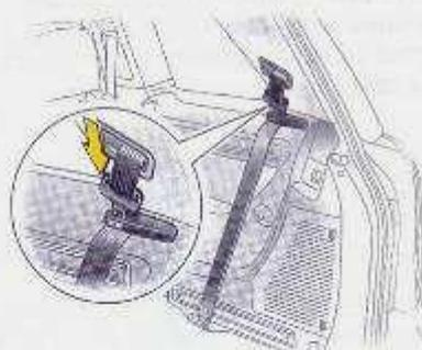
Faire passer les ceintures de sécurité dans le support de ceinture et insérer les verrous plats dans les supports.
