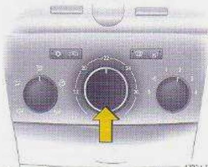
Mettre le commutateur rotatif à la position souhaitée. Les réglages intermédiaires sont possibles. La température présélectionnée sera maintenue constamment. Pour garantir le confort, ne régler la température que progressivement.
