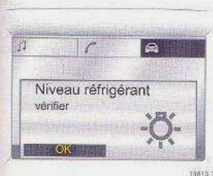
Niveau de liquide du circuit de refroidissement moteur trop bas. Vérifier immédiatement le niveau de liquide de refroidissement ↻ 10-3.
