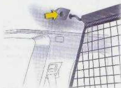
17393 T Deux orifices de montage \* se trouvent dans le cadre du toit: accrocher d'un côté puis enclencher la barre du filet afin de l'accrocher, presser la barre, l'accrocher d'un côté et l'enclencher.
