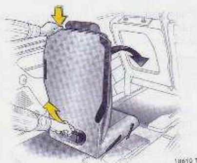
A partir du coffre, appuyer sur la touche en haut du dossier de siège, basculer le dossier vers l'avant. Tirer le siège en haut vers l'arrière au niveau de la poignée et ensuite, le basculer vers l'avant jusqu'à ce qu'il soit noyé dans le plancher du véhicule. Tenir le siège à la poignée pendant tout le processus de basculement.
