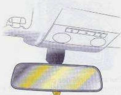
Pour réduire l'éblouissement, basculer le levier au bas du boîtier de rétroviseur sur le côté.
