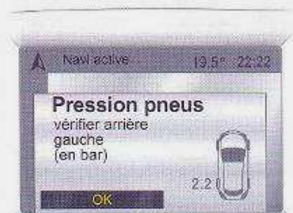
Sur les véhicules avec système de contrôle de la pression des pneus, un message indique la roue à vérifier lorsque la pression est trop basse.
