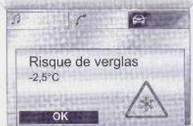
Sur les véhicules avec affichage d'informations graphique ❄️ ou affichage d'informations couleur ❄️, un message d'avertissement apparaît pour signaler un risque de chaudière verglacée. Aucun message n'apparaît pour des températures inférieures à -5 °C.
