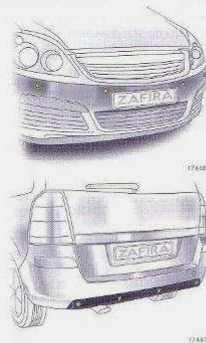
L'aide au stationnement facilite le stationnement en mesurant la distance entre l'avant et l'arrière du véhicule et un obstacle. Il ne délivre pas le conducteur de sa responsabilité de se garer.
