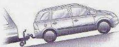
Sur les véhicules à boîte manuelle, le régime du moteur le plus favorable pour embrayer se situe, sur les moteurs essence, entre 2500 et 3000 tr/min ; sur les moteurs Diesel, entre 2000 et 2200 tr/min. Maintenir ce régime constant, embrayer en faisant patiner l'embrayage – relâcher le frein à main – et appuyer à fond sur l'accélérateur. Le régime du moteur ne doit, si possible, pas diminuer.
