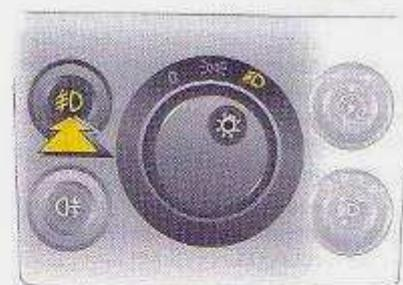
Les phares antibrouillard s'allument uniquement avec le contact d'allumage mis et les feux allumés.
