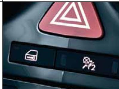
◀ **Airbag passager désactivable.** L'airbag frontal du passager avant peut être désactivé, ce qui permet d'installer un siège-enfant ou un berceau de sécurité à l'avant. L'état de cet airbag s'affiche sur l'interrupteur et au tableau de bord.
