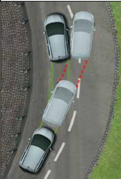
◀ **Programme électronique de stabilité (ESP<sup>®Plus</sup>), en option.** Vous maîtrisez la situation: agissant sur les freins des quatre roues, le système garantit une excellente stabilité de cap, même en cas de sous-virage extrême, par exemple lors des manœuvres d'évitement. (Désactivable sur la Corsa GSi.)
