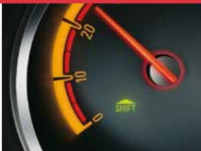
◀ **Indicateur de changement de vitesse.** Intégré au compte-tours, il signale au conducteur le meilleur moment pour passer la vitesse supérieure, ce qui lui permet d'économiser du carburant. (Sur les modèles avec moteur à essence Euro 5 et sur la Corsa 1.3 CDTI **ecoFLEX** de 70 kW/95 ch.)
