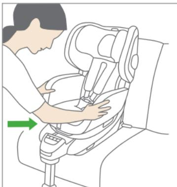
Heben Sie den Griff in der Mitte an und schieben Sie den RECARO Zero.1 Richtung Rückenlehne bis diese anliegt.
