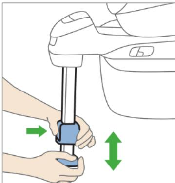
For at indstille højden af støttefoden skal du først skubbe støttefoden opad indtil anslaget og derefter betjene låsen på forsiden af støttefoden. Træk derefter støttefoden ud, indtil den står sikkert på gulvet. Sørg for, at støttefoden falder sikkert i hak, når du slipper låsetasten.
