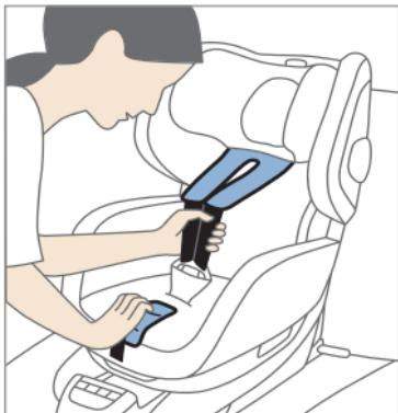
För att lossa bältet använder man bältesjusteringsknappen och drar axelbältena framåt enligt bilden.
