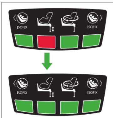
Bei richtig eingestellter Länge wechselt die Anzeige für den Stützfuß auf Grün sobald Sie den Stützfuß auf dem Fahrzeugboden abstellen. Sollte dies nicht der Fall sein, fahren Sie den Stützfuß wie oben beschrieben noch etwas weiter aus.
