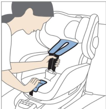
Per allentare le cinture azionare il tasto di regolazione e tirare le cinture per le spalle in avanti, come indicato nella figura.
