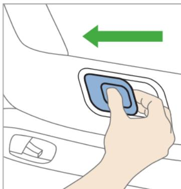
Pentru deblocarea funcției de rotire, împingeți în jos tasta de pe mijlocul manetei de reglare și trageți-o în exterior. Puteți roti în lateral scoica.
