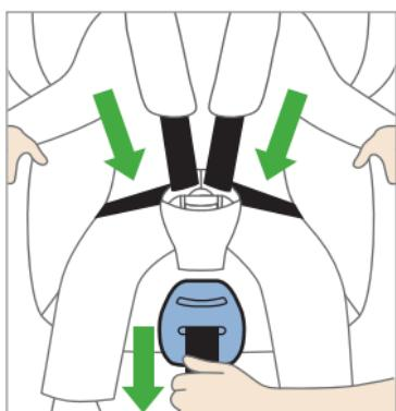
Tendere la cintura tirando la cintura di regolazione. Quanto più la cintura è tesa, tanto più il bambino è sicuro nel RECARO Zero.1 Pertanto quando il bambino è nell'autovettura si raccomanda di spogliarlo da giacche o maglioni pesanti.
