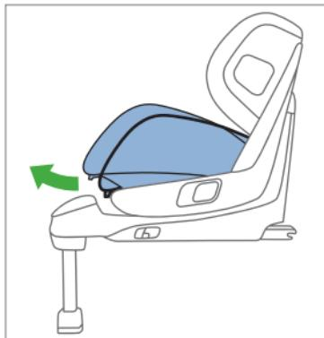
Ist die gewünschte Position erreicht lassen Sie den Hebel los und lassen ihn einrasten. Überprüfen Sie das sichere Einrasten durch Drücken oder Ziehen an der Sitzschale
