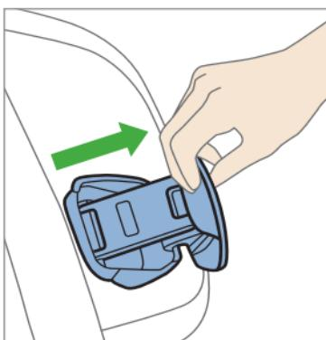
Abyste zvýšili bezpečnosť při případné nehodě, aktivujte ochranu dětské sedačky proti bočnímu nárazu. Zvedněte k tomu ochranu proti nárazu na straně dětské sedačky otočené ke dveřím vozidla. Zkontrolujte bezpečné zablokování zatlačením na ochranu proti nárazu.
