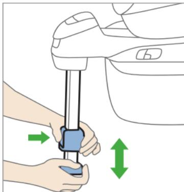
Para ajustar la altura del pie de apoyo, desplácelo en primer lugar hacia arriba hasta el tope y pulse el bloqueo de la parte delantera del pie de apoyo. Ahora, tire del pie de apoyo hasta que quede plantado sobre el piso del vehículo con estabilidad. Procure que el pie de apoyo encaje de forma segura después de soltar el botón del bloqueo.
