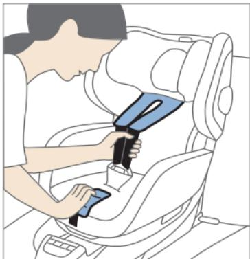
Za sprostitev varnostnih pasov, pritisnite gumb za nastavitev pasov in izvlecite ramenska pasova v smeri naprej, kot je prikazano.
