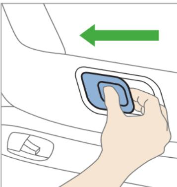
Zum Entriegeln der Drehfunktion schieben Sie zuerst die Taste in der Mitte des Verstellhebels nach unten und ziehen diesen nach außen. Sie können die Sitzschale nun zur Seite drehen.
