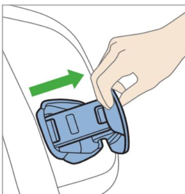
Afin de renforcer la sécurité de votre enfant en cas d'accident, actionnez la protection supplémentaire contre les chocs latéraux. Pour cela, dépliez la protection située sur le côté du siège correspondant au côté de la portière du véhicule. Vérifiez que la protection est bien enclenchée en appuyant dessus.
