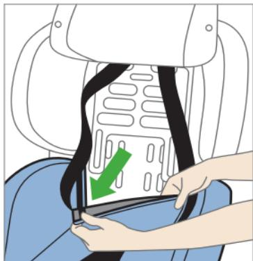
Zum Abnehmen des unteren Bezugsteils öffnen Sie zunächst die Klettverschlüsse im Rückenbereich.
