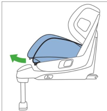
Quando si è raggiunta la posizione rilasciare la leva e farla scattare in posizione. Verificare che scatti correttamente in posizione spingendo o tirando la struttura del seggiolino.
