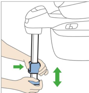
Pour régler la hauteur du pied d'appui, poussez d'abord le pied d'appui jusqu'à la butée vers le haut et activez le verrouillage sur la face avant du pied d'appui. Retirez maintenant le pied d'appui jusqu'à ce qu'il repose en toute sécurité sur le sol du véhicule. Veillez à ce que le pied d'appui s'enclenche correctement lorsque vous lâchez la touche de verrouillage.
