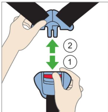
Abra el dispositivo de cierre del cinturón pulsando la tecla roja y saque hacia arriba las hebillas de cierre.
