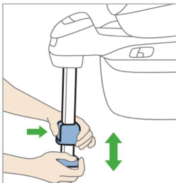
Za nastavitev višine oporne noge najprej porinite nogo do konca navzgor in nato pritisnite na zaporo na sprednji strani oporne noge. Nato iztegnite oporno nogo tako, da se bo varno naslonila na pod vozila. Ko zaporo izpustite, se mora oporna noga varno zaskočiti.
