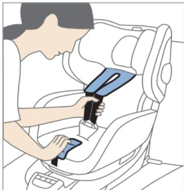
Az övek meglazításához nyomja meg az öv beállító gombot és az ábrán látható módon húzza előre a vállöveket.
