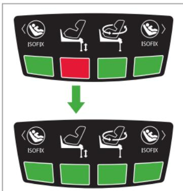
Če ste pravilno nastavili dolžino, se indikator za podporno nogu obarva zeleno takoj, ko podporno nogu postavite na tla vozila. Če se to ne zgodi, podporno nogu še nekoliko izvlecite, kot je opisano zgoraj.
