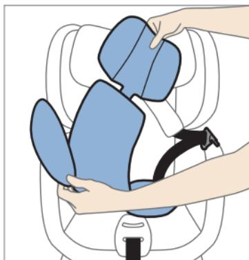
Para sacar el reductor del asiento, abra el dispositivo de cierre y saque los cinturones hacia fuera. A continuación, extraiga el reductor del asiento. Consérvelo en un lugar seco y protegido contra el polvo por si quisiera volver a utilizarlo en el futuro.
