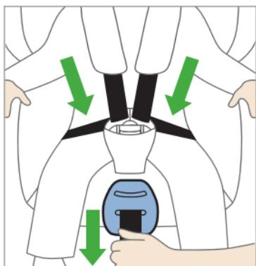
Napněte pás zatažením za nastavovací popruh. Čím pevněji přiléhá pás k vašemu dítěti, tím bezpečněji je uloženo v sedačce RECARO Zero.1. Doporučuje se proto dítěti svléknout silnější bundu nebo svetr.
