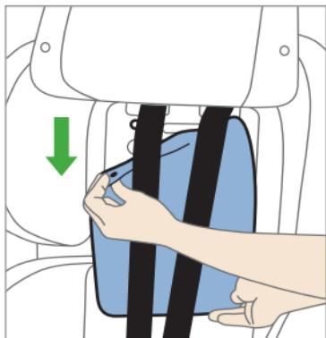
Ryggpolsteret er fastgjort på nakkestøtten med trykknapper. Når du har åbnet dem, kan du trække polsteret af nedad.
