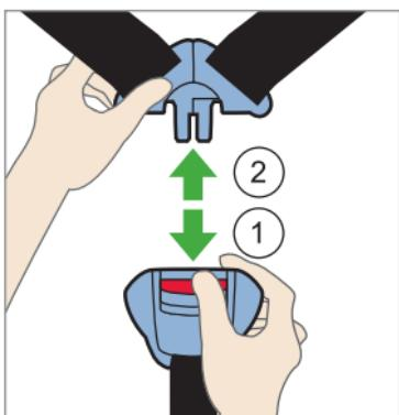
Öffnen Sie das Gurtschloss durch Druck auf die rote Taste und ziehen Sie die Schlosszungen nach oben heraus.
