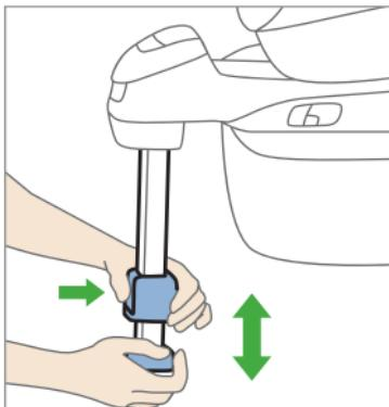
Zum Einstellen der Stützfußhöhe schieben Sie zunächst den Stützfuß bis zum Anschlag nach oben und betätigen Sie die Verriegelung an der Vorderseite des Stützfußes. Ziehen Sie nun den Stützfuß aus bis er sicher auf dem Fahrzeugboden aufsteht. Achten Sie darauf, dass der Stützfuß nach dem loslassen der Verriegelungstaste sicher einrastet.
