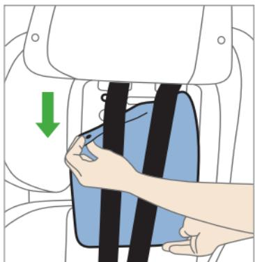
A hátpárna nyomógombokkal van rögzítve a fejtámlához. Ezek nyitását követően a párna lefelé kihúzható.
