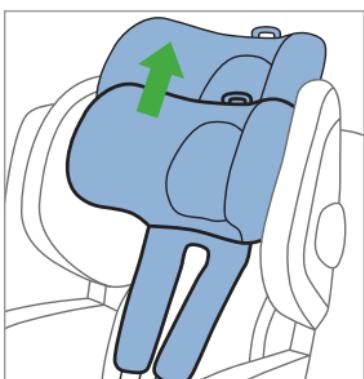
Verschieben Sie nun die Kopfstütze in die gewünschte Position und lassen Sie die Verriegelung einrasten.
