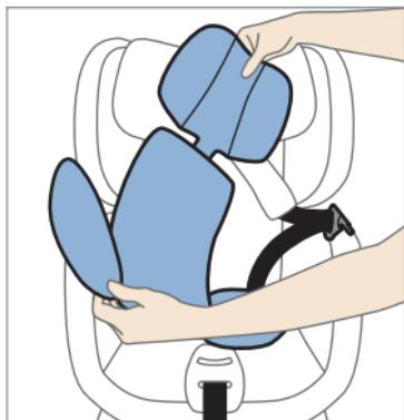
Pour retirer le réducteur de siège, ouvrez la boucle du harnais et posez la ceinture vers l'extérieur. Retirez ensuite le réducteur de siège. Conservez-le dans un endroit sec à l'abri de la poussière pour une éventuelle utilisation ultérieure.
