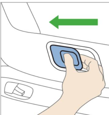
Per sbloccare la funzione di rotazione spingere anzi tutto verso il basso il tasto al centro della leva di regolazione e tirarla verso l'esterno. Ora è possibile ruotare la struttura di lato.
