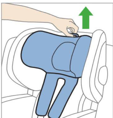
Přesuňte pak opěrku hlavy do požadované polohy a nechte zaklapnout pojistku.
