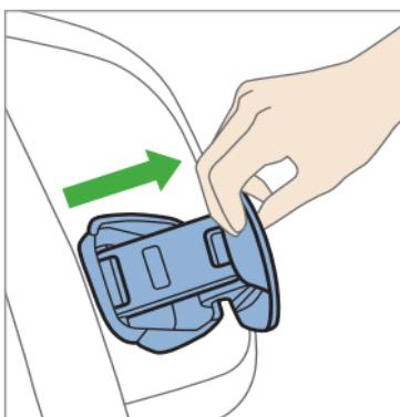
Za večjo varnost v primeru nesreče aktivirajte stranski zaščitni element. To storite tako, da dvignete zaščitni element na strani avtosedeža, ki je obrnjena proti avtomobilskim vratom. S pritiskom na zaščitni element preverite, ali je trdno zaskočen.
