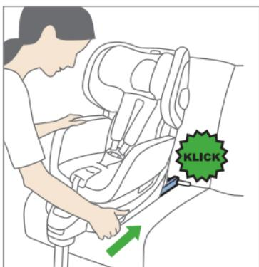
A continuación, coloque el RECARO Zero.1 en los conectores ISOFIX y deje que se encajen de forma audible.
