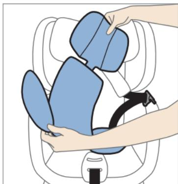
Chcete-li vyjmout zmenšovací vložku dětské sedačky, otevřete zámek bezpečnostních pásů sedačky a pásy položte ven. Poté zmenšovací vložku vyjměte. Zmenšovací vložku uschovejte pro budoucí použití na suchém místě, chráněném před prachem.
