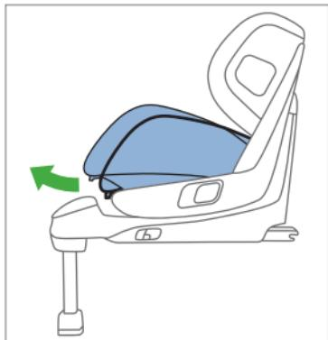
Po dosažení požadované polohy uvolněte páčku a nechte ji zavknout. Zkontrolujte bezpečné zablokování stisknutím nebo potažením sedáku.
