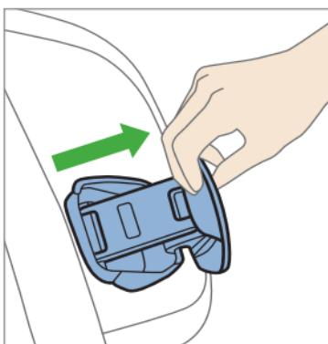
Per migliorare la sicurezza in caso di incidente, attivare la protezione antiurto laterale del seggiolino, sollevando l'apposita aletta sul lato del seggiolino rivolto verso la portiera del veicolo. Controllare che l'aletta sia saldamente scattata in posizione esercitandovi una certa pressione.
