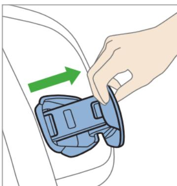
Para mejorar la seguridad en caso de accidente, active la protección de impacto lateral de la silla de auto. Para eso, levante el protector antichoque del lado de la silla de auto orientado del lado de la puerta del vehículo. Para comprobar que se puso de forma segura, ejerza presión sobre el protector antichoque.
