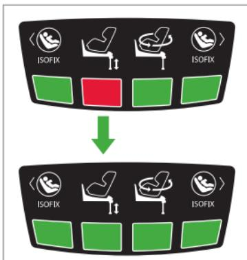
Ved en korrekt indstillet længde skifter visningen for støttefoden til grøn, så snart du stiller støttefoden på bunden af bilen. Hvis det ikke er tilfældet, skal du køre støttefoden lidt længere ud, som beskrevet foroven.
