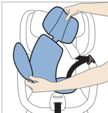
För att ta ut spädbarnsinsatsen öppnar man bältet och lägger dem ut på sidan. Därefter kan spädbarnsinsatsen tas av. Förvara den på en torr och dammskyddad plats för eventuellt framtidiga bruk.
