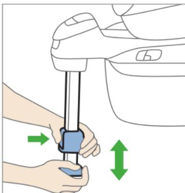
Per regolare l'altezza del piede di supporto spingere quest'ultimo verso l'alto fino all'arresto e azionarne in seguito il bloccaggio sulla parte anteriore. Estrarre ora il piede finché non poggia in modo sicuro sul pianale del veicolo. Assicurarsi che dopo aver lasciato il tasto di bloccaggio il piede di appoggio scatti in posizione.
