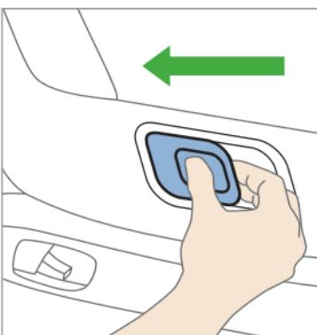
K odblokování otočné funkce přesuňte nejdříve tlačítko pojistky uprostřed dolů a pak jej vytáhněte ven. Sedák můžete pak otočit do strany.
