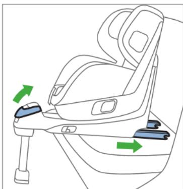
Para extender los conectores ISOFIX, accione la palanca delantera, situada por encima del pie de soporte y tire de los conectores hasta que hagan tope.
