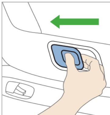
Para desbloquear la función de giro empuja el botón de ajuste hacia abajo y levante la tecla hasta usted. Ahora ya se puede girar la silla de auto hacia el lado.
