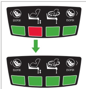
Při správném nastavení délky se ukazatel opěrné nohy změní na zelenou, jakmile postavíte opěrnou nohu na podlahu vozidla. Pokud tomu tak není, vysuňte opěrnou nohu ještě více postupem popsaným výše.
