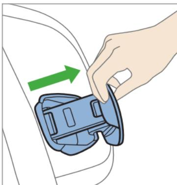
Um die Sicherheit bei einem eventuellen Unfall zu verbessern, aktivieren Sie den Seitenauflaufschutz des Kindersitzes. Heben Sie dazu den Aufprallschutz an der der Fahrzeugtür zugewandten Seite des Kindersitzes an. Kontrollieren Sie das sichere Einrasten durch Druck auf dem Aufprallschutz.
