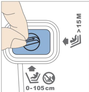
Dacă doriți să folosiți ulterior scaunul pentru copii orientat înainte, atunci demontați întâi scaunul. (a se vedea capitolul 8.)
