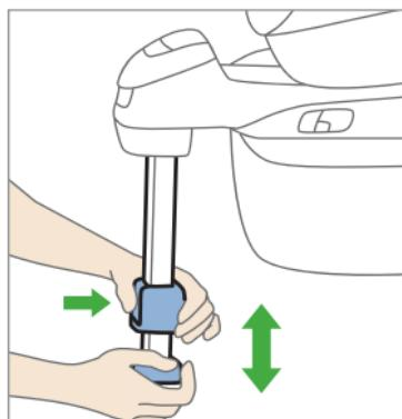
Pro nastavení výšky opěrné nohy posuňte nejdříve opěrnou nohu až na doraz nahoru a stiskněte knoflik uzamykacího mechanismu na přední straně opěrné nohy. Nyní opěrnou nohu vytáhněte tak, až se bezpečně postaví na podlahu vozidla. Zkontrolujte, zda opěrná noha bezpečně zavakla poté, co pustíte tlačítko uzamykacího mechanismu.
