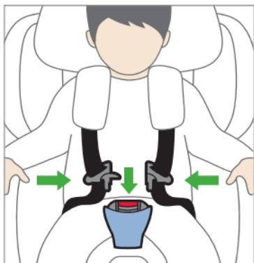
Una las grapas del e insértelas en el dispositivo de cierre del cinturón. Deje que encajen de forma audible.
