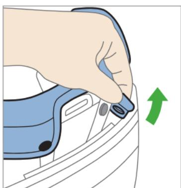
Öffnen Sie nun die Druckknöpfe an der Rückseite der Kopfstütze.
