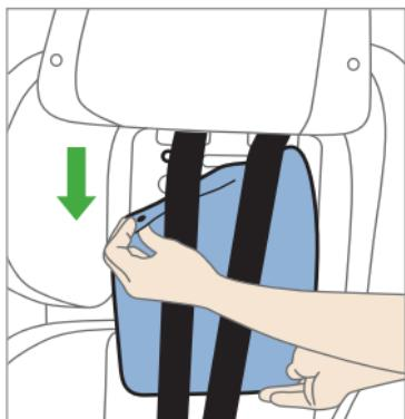
Polstrování zad je upevněno tlakovými knoflíky na opěrce hlavy. Po jejím otevření můžete stáhnout polstrování dolů.
