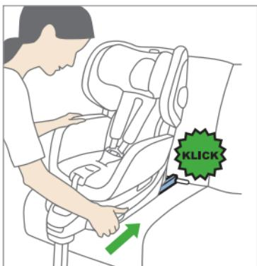
Pak nasadte RECARO Zero.1 na rukojeti ISOFIX a nechte konektory slyšitelně zaklapnout.
