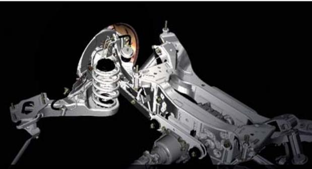
**Les suspensions arrière multibras** garantissent la stabilité en virage et à haute vitesse.
