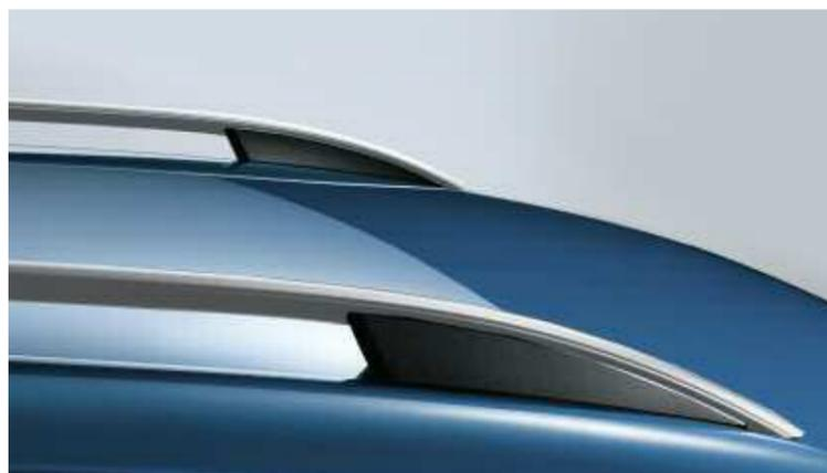
Des **rampes de pavillon bi-ton** (finition alu et noire) permettent de fixer différents systèmes porteurs pour vélos, skis, planches de surf et autres matériels encombrants.
