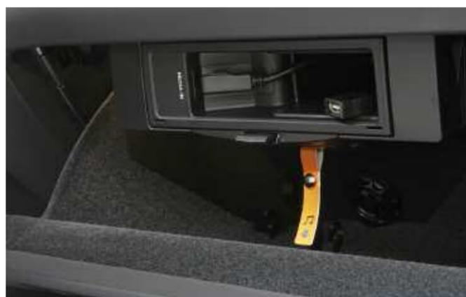
"MEDIA-IN" Interface multimédia USB. Situé dans la boîte à gants pour iPod de 4<sup>ème</sup> génération, lecteur MP3 ou clé USB. Il permet la lecture des formats audio MP3, WMA, OGG Vorbis, AAC via le système radio / radionavigation. Affichage des plages sur l'écran de la radio / radionavigation. Un adaptateur pour iPod est disponible en accessoire en option.
