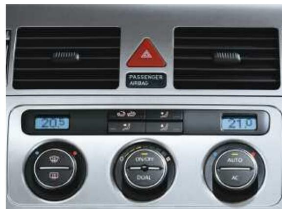
La climatisation "Climatronic" règle automatiquement le débit et la répartition de l'air pour deux zones et maintient constante la température choisie. La réfrigération de la boîte à gants est réglable.
