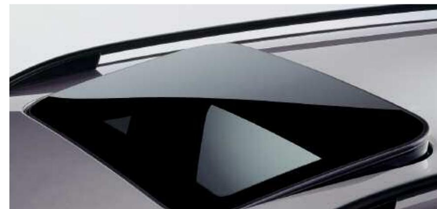
Le toit ouvrant coulissant/entrebâillable électrique en verre avec pare-soleil intégré s'ouvre en appuyant sur un bouton.
