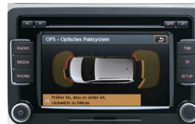
Sur les véhicules à la fois équipé de radars de stationnement et des radios RCD 310/510 et navigation RNS 510, l'écran permet de visualiser les obstacles.
