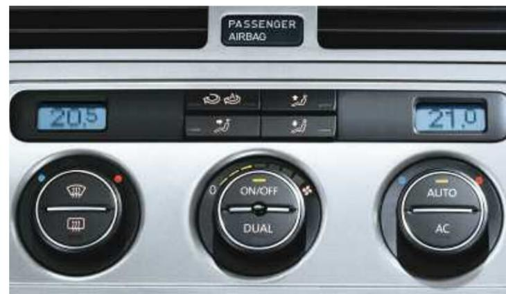
La climatisation "Climatronic" règle électroniquement la température en deux zones pour le conducteur et le passager avant. Température, débit et répartition de l'air se règlent séparément (de série sur Confortline).
