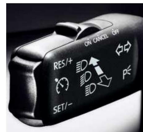
Le régulateur de vitesse est un élément de confort particulièrement appréciable sur les longs trajets. Il permet de maintenir constante n'importe quelle vitesse sélectionnée à partir de 30 km/h.
