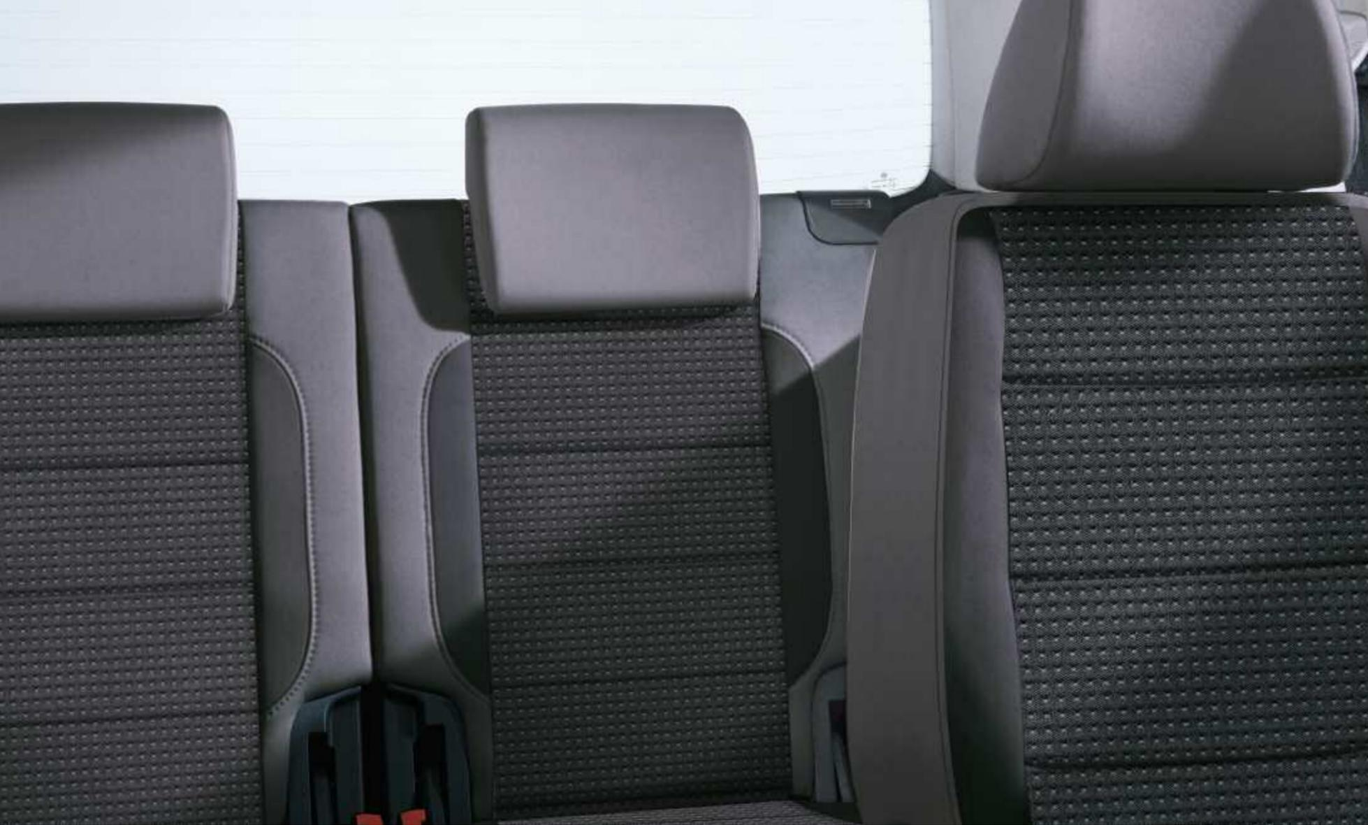
La troisième rangée de sièges permet de transformer le Touran en véhicule 7 places. Les deux sièges individuels peuvent s'escamoter séparément dans le plancher de coffre.
