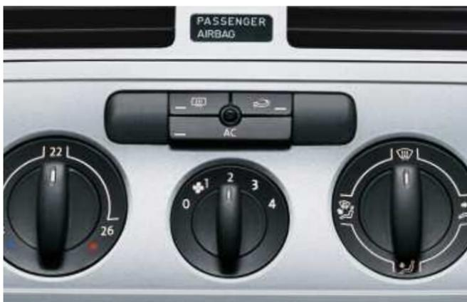
La climatisation semi-automatique "Climatic" est réglable par paliers et maintient constante la température choisie (de série sur Trendline).
