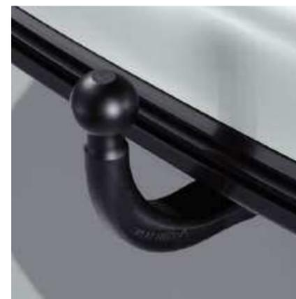
Le crochet d'attelage est amovible et permet de tracter jusqu'à 1 800 kg.
