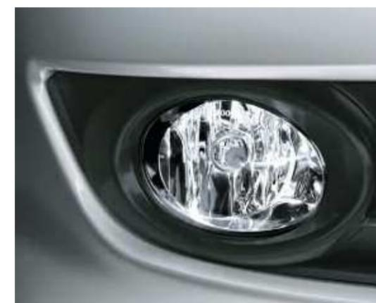
Les **phares antibrouillard** intégrés au pare-chocs avant améliorent la visibilité lors des intempéries. Ils intègrent en outre une fonction éclairage d'intersection.
