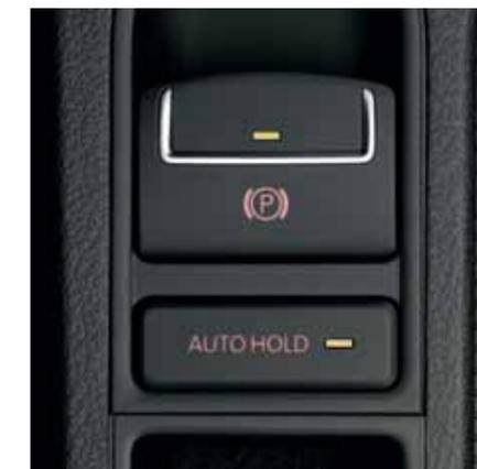
Frein de stationnement électronique avec fonction 'Auto-Hold'. Le démarrage en côte n'a jamais été aussi facile. Un simple bouton permet d'assurer le maintien en position du Tiguan, et le frein est automatiquement déverrouillé en appuyant sur l'accélérateur (de série).
