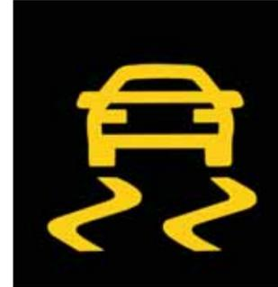
ESP (correcteur électronique de trajectoire). Cet ESP de nouvelle génération régule le survirage et le sous-virage du véhicule dans les courbes. Lorsque le véhicule tracte une remorque, c'est le système de stabilisation de l'attelage qui le maintient sur sa trajectoire. En cas de tonneau, des systèmes de sécurité intelligents déclenchent en quelques fractions de secondes les tensionneurs de ceintures de sécurité et des airbags (de série).
