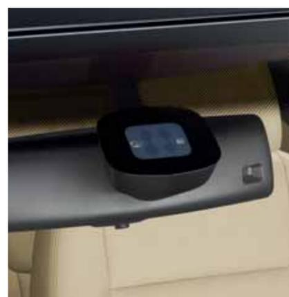
Le 'Pack Visibilité 1'. Outre deux spots d'éclairage dans la zone inférieure de l'habitacle à l'avant, l'allumage automatique des feux de croisement, les fonctions 'Coming home' et 'Leaving home' ainsi que le basculement automatique du rétroviseur intérieur en position nuit, il comprend également un capteur de pluie qui gère automatiquement la fréquence des essuie-glaces en fonction de l'intensité des précipitations (de série à partir de 'Sportline').
