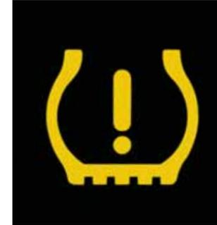
Système de contrôle de la pression des pneus. En cas de variation de la pression sur l'un des quatre pneus, un symbole d'avertissement s'affiche sur l'écran multifonction. Le conducteur est ainsi informé en temps utile dès que des variations de pression se produisent (de série sur finition 'Tiguan' 4Motion, 'Track & Field', 'Sportline' et version 'Carat').
