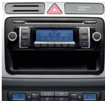
L'autoradio 'RCD 310' est équipé d'un lecteur de CD, de huit haut-parleurs et d'une prise audio externe. Il lit les formats MP3 et WMA et possède une puissance de sortie de 4 x 20 watts. Série sur Sportline.
