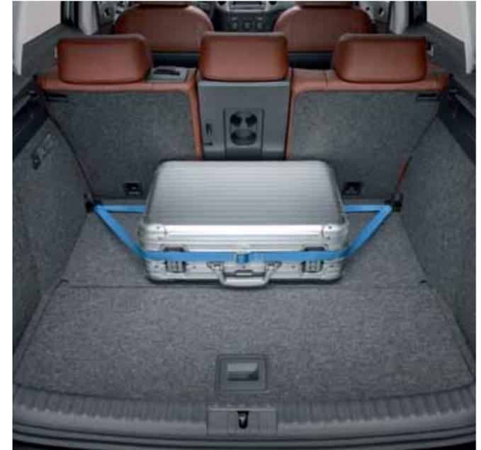
Anneaux d'amarrage dans le coffre. Cet accessoire pratique permet de fixer et de sécuriser le chargement du coffre (de série).
