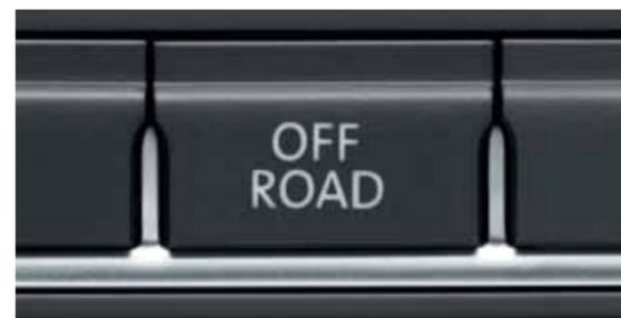
Programme de conduite Offroad. Un simple bouton permet d'adapter le Tiguan aux conditions de conduite tout-terrain délicates. Ce programme intègre entre autres un assistant de descente et un système d'aide au démarrage en côte et facilite la conduite hors routes (de série sur finition 'Tiguan' 4Motion, 'Track & Field', 'Sportline' et 'Carat' 4 roues motrices 4Motion).
