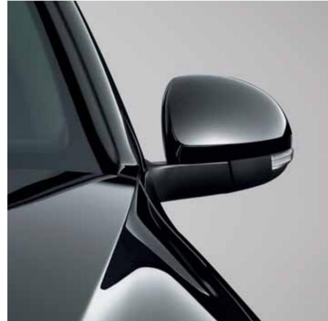
Clignotants latéraux. Intégrés dans les rétroviseurs extérieurs, ils sont bien visibles et jouent un rôle à la fois fonctionnel et esthétique (de série).
