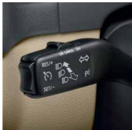
Régulateur de vitesse. Il maintient la vitesse choisie par le conducteur (à partir de 30 km/h) et contribue ainsi au confort de la conduite, en particulier lors de longs trajets sur autoroute (de série).
