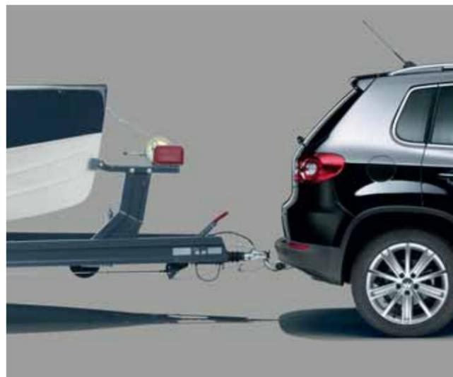
Attache de remorque escamotable manuellement : Repliable, elle permet de tracter jusqu'à 2,5 t et se dissimule derrière le pare-chocs arrière, évitant ainsi un montage et un démontage fastidieux (en option).
