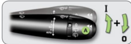
Il est commandé manuellement par le conducteur en déplaçant la commande **A** vers le haut et en la replaçant en position «**0**».
