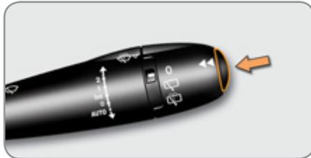
☞ Appuyez sur le bouton, situé à l'extrémité de la **commande d'essuie-vitre**, pour afficher successivement les différents onglets de l'ordinateur de bord.
