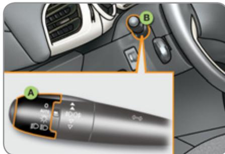
**A.** bague de sélection du mode d'éclairage principal, avec :
