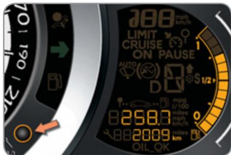
Les kilométrages total et journalier sont affichés pendant trente secondes à la coupure du contact, à l'ouverture de la porte conducteur, ainsi qu'au verrouillage et au déverrouillage du véhicule.
