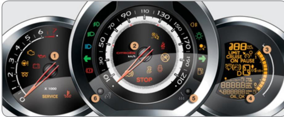
Panneau regroupant les cadrans et les témoins d'indication de fonctionnement du véhicule. Selon les versions, ce combiné peut avoir un rétro-éclairage permanent.
