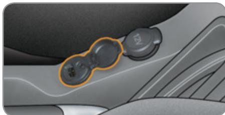
Ce boîtier de connexion, composé d'une prise JACK et d'un port USB, est situé sur la console centrale.
