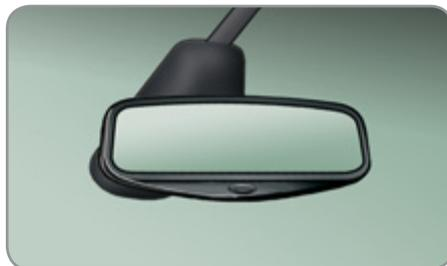
Afin d'éviter l'éblouissement, le miroir du rétroviseur intérieur s'assombrit automatiquement en fonction de l'intensité lumineuse provenant de l'arrière.
