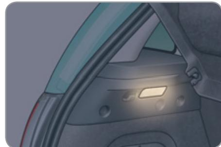
Il s'allume automatiquement à l'ouverture et s'éteint automatiquement à la fermeture du coffre.
