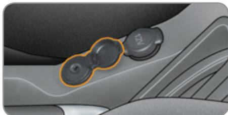
Ce boîtier de connexion, composé d'une prise JACK, est situé sur la console centrale.
