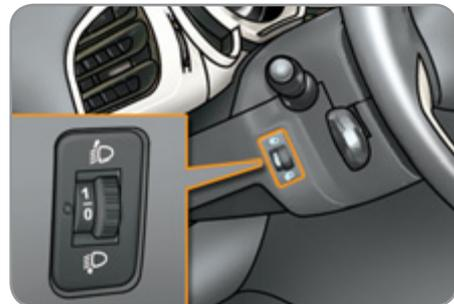
Pour ne pas gêner les autres usagers de la route, les projecteurs doivent être réglés en hauteur, en fonction de la charge du véhicule.
