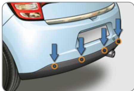
Il détecte tout obstacle (personne, véhicule, arbre, barrière...) derrière le véhicule, sauf les obstacles situés juste sous le pare-chocs.
