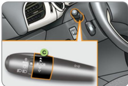
**C.** bague de sélection des feux antibrouillard.
