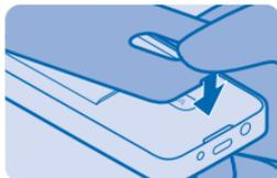
6. Pour mettre le téléphone sous tension, maintenez la touche
